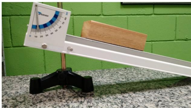
6. Aumente lentamente a inclinação da rampa até que o corpo de prova comece a deslizar e verifique o ângulo indicado no goniômetro. Repita pelo menos 5 vezes este procedimento, determine o ângulo médio e anote sua respectiva tangente.
