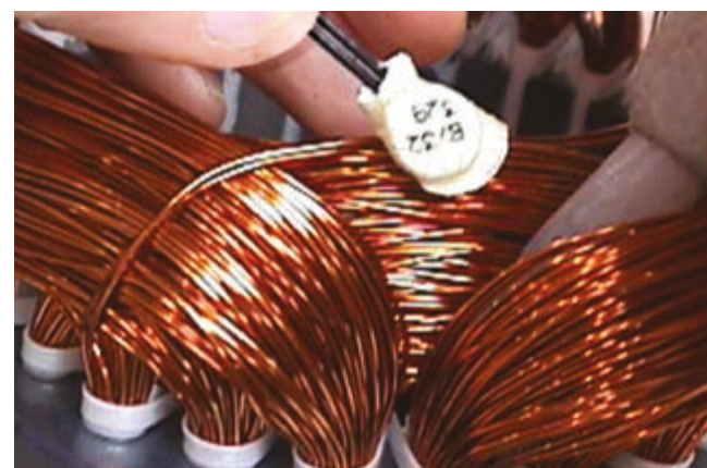
Figura 7.6 - Instalação do protetor térmico bimetálico
