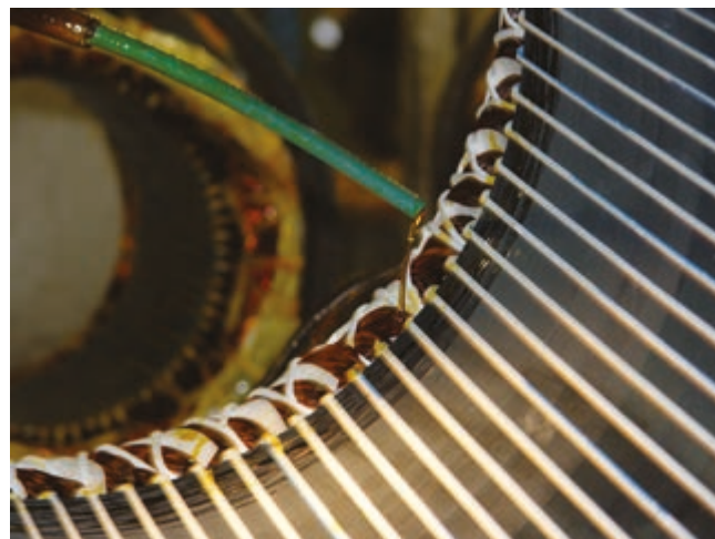
Figura 1.12.c – Fluxo contínuo de resina
