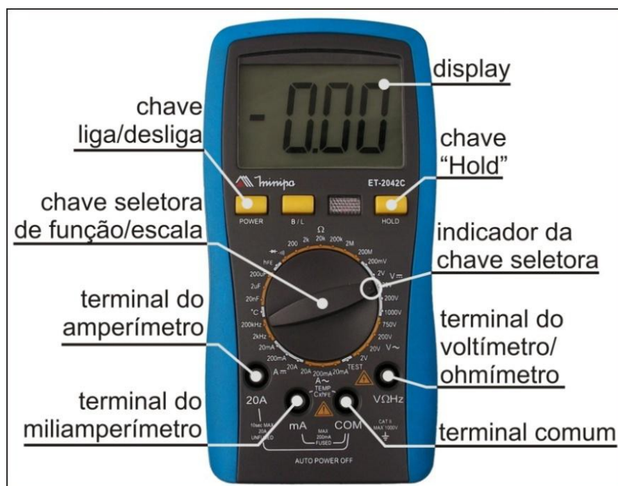
Figura 3: Principais componentes de um multímetro digital
